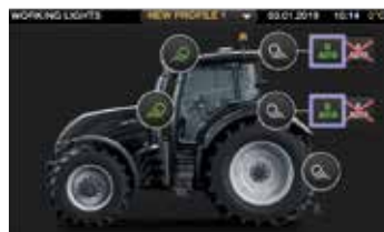
Nastavení hydraulických okruhů (čas a průtok). Vyberte si, kterým ovládacím prvkem budete ovládat hydraulické okruhy, přední a zadní tříbodový závěs a čelní nakladač.
