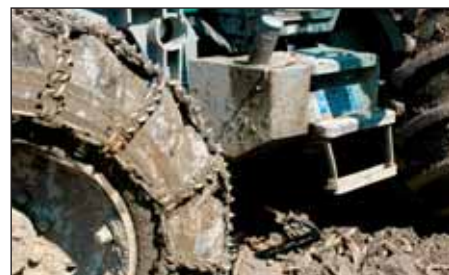
Ďalšími lesnými úpravami prešli kolesá so špeciálnym diskom s ochranou ventilu s osadenými vynikajúcimi radiálnymi pneumatikami Nokian a oceľovou nádržou na naftu.
