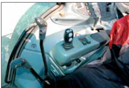
Výrobca Valtra dodal traktor už z výroby s joystickom pre čelný nakladač – ideálna predpríprava pre čelný nakladač.
