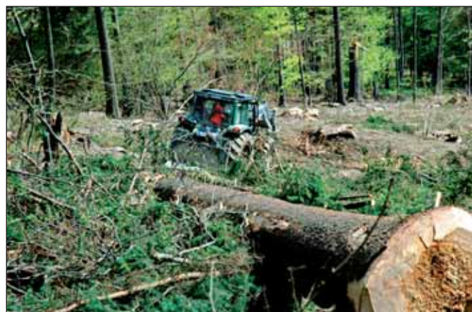
Valtra na hranici svahovej dostupnosti navijakom sťahuje drevo.
